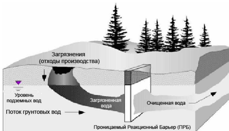
Рис.1.6. Схема проницаемого реакционного барьера
